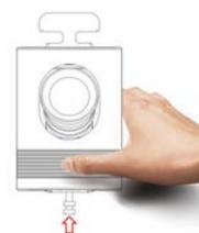
На следующем шаге, возьмитесь рукой за поводки камер и, поворачивая камеры вокруг своей оси, совместите вертикальную линию креста и центральную синюю вертикальную линию на виде с каждой из камер, как показано на рисунке ниже. После этого зафиксируйте винты крепления.
