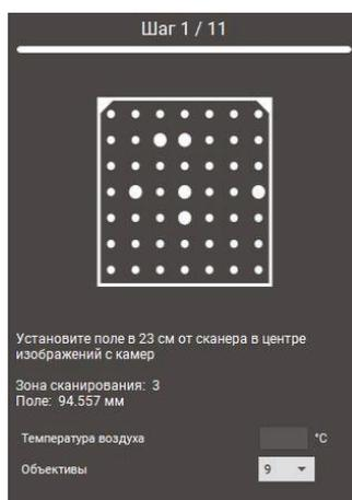
После того, как все необходимые снимки будут сняты, дождитесь окончания расчета. Результирующая точность калибровки указывается в пикселях. Хорошим значением можно считать результирующую точность не хуже (не больше) 0.1 pix. При получении более высоких значений калибровки повторите калибровку, внимательно следя за освещенностью поля и его положением.
